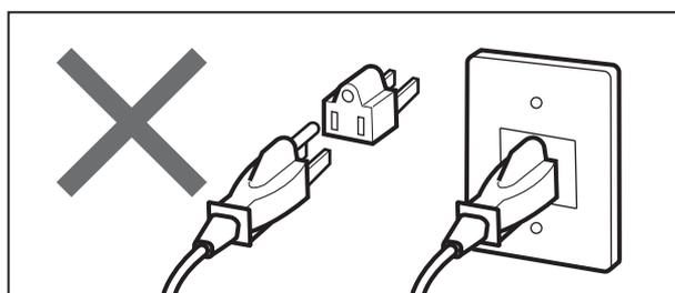
AC100Vのケーブルは、必ずアース付きの3Pコンセントへ差し込み確実にアースをとってください。3P⇒2Pの変換プラグなどは絶対に使用しないでください。
