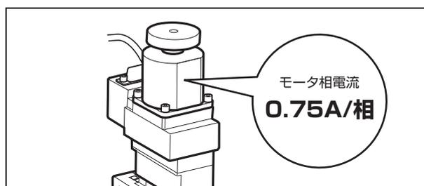
本製品で、駆動できるモータの相電流は0.75A/相です。これと異なる（例えば1.4A/相などの）モータは駆動しないでください。また、指定以外の結線方式のモータも使用しないでください。
