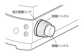
①カプラは、ピント調節ハンドル部の「固さ調整リング」に取り付けます。取り付ける顕微鏡の「固さ調整リング」を確認してください。
