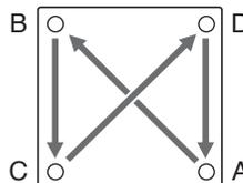
A→B→C→Dの順序で徐々に締め付けます。3050シリーズの場合は、低頭ねじ6本を使用して、同様に離れた対角線上のねじを締めてください。
