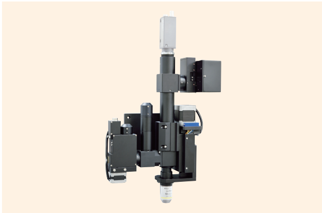
↑ AF-IZS2-N60WP 自动对焦显微镜 (AF-IZ 型) 组合·选择例 (衍生型号)
