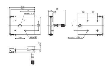
TD-202 二軸マイクロメーター式傾斜ステージ ¥ 60,000
