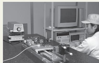
超精密レーザー測定システムによるXステージの検査
