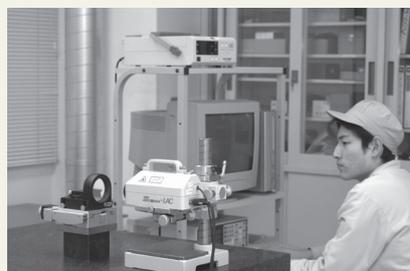
「レーザーオートコリメータ LAC-S」による傾斜ステージの検査
