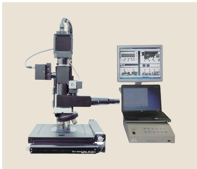
▲ AF-WF オートフォーカス顕微鏡 (広視野タイプ) 構成例
