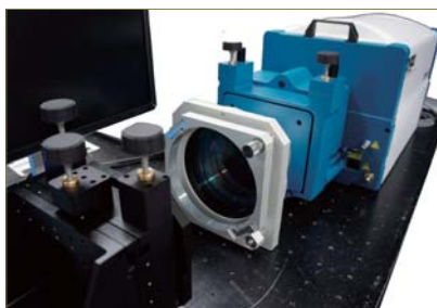
↑ 干渉計用ビームエキスパンダ(清原光学製) ZYGO干渉計に互換性
