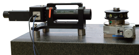
写真 4-4-1 位置決め精度測定
