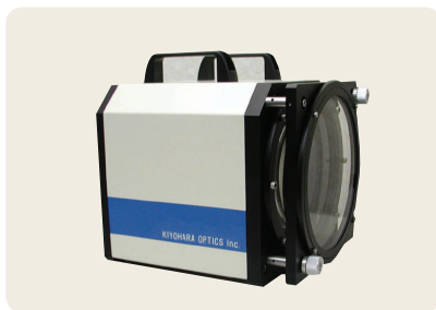
▲ 干渉計用ビームエキスパンダ(清原光学製) φ 200用 ZYGO干渉計に互換性
