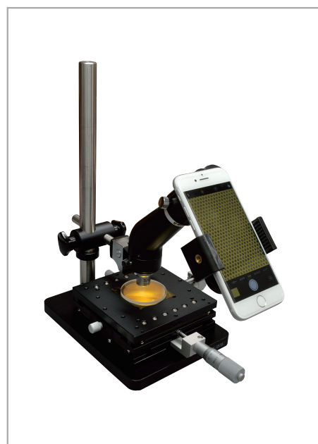
透過型XYステージと組み合わせた観察の例
