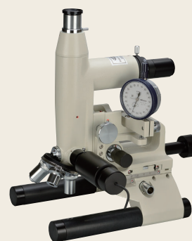
ロールスコープ用ダイヤルゲージ 取り付け例
