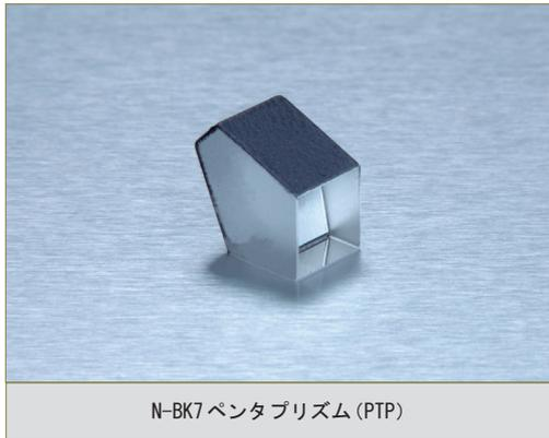
ペンタプリズムは2度の反射により光路を90°偏角する機能を持ち、この時の像は正立でしかも左右は反転していません。反射2面にはアルミコートをし、その上を更にインコネル、および黒色塗装で保護しています。
