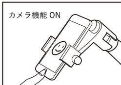
⑤ スマートフォンのカメラ機能を起動させ観察像を確認します。スマートフォン画面で視野欠けがある場合は、裏面ねじを少しずつ緩めカメラレンズ位置を調整してください。
